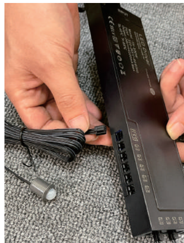
4. Stecken Sie den Empfänger der Fernbedienung in den 3-poligen Anschluss.
