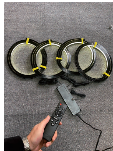
6. Testen Sie alle Funktionen des kompletten Beleuchtungssets.
