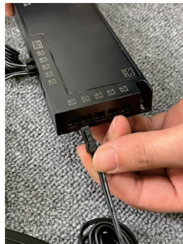
5. Stecken Sie die LED-Lichtbänder in die Anschlüsse des Netzteils.
